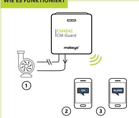
Der Mobeye CM4042 überwacht verschiedene Fehlerkontakte oder Sensoren in Ihrer Installation und bietet die Möglichkeit ein Gerät, eine Pumpe oder einen Motor aus der Ferne zu schalten.
