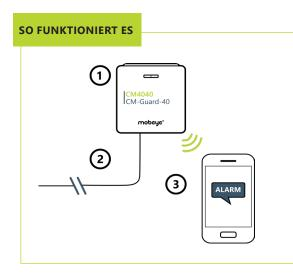
Der Mobeye CM4040 überwacht Ihre Installation aus der Ferne. Nach einem Eingangsalarm sendet der Alarmmelder sofort eine Benachrichtigung mit Klartext für jeden Eingang.
